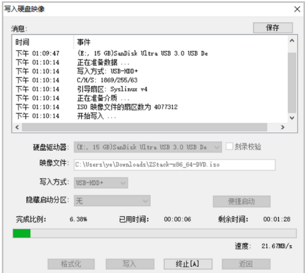
图 6: 在UltraISO确认写入ISO镜像
